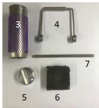
3) Corer 4) Handle 5) Metal cap 6) Hammer block 7) Crossbar
